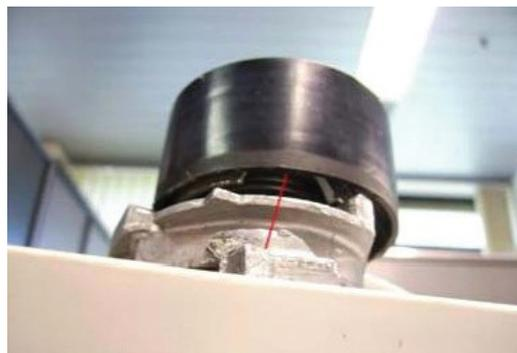
Gates recomienda el kit de distribución con bomba de agua TCKWP335 para realizar un correcto mantenimiento preventivo, ya que debido al desajuste en la bomba de agua posiblemente se dañe el sello.
