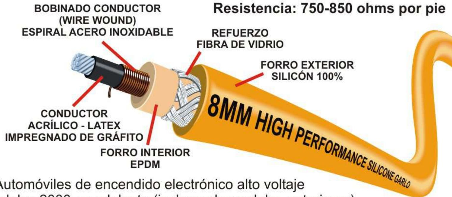
RECOMENDADO PARA: Automóviles de encendido electrónico alto voltaje y alto rendimiento. Para modelos 2000 en adelante (incluyendo modelos anteriores).
