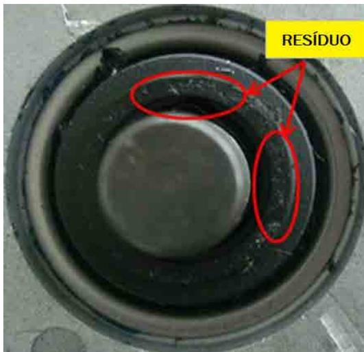
6) Quando resíduos de selante ficam presos entre as faces de vedação, causam uma separação das duas superfícies, levando a um vazamento.
