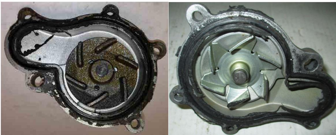
3) Ambas as bombas d'água foram fornecidas com uma junta metálica com revestimento de borracha no perímetro interno. Este tipo de junta não necessita de nenhum selante.
