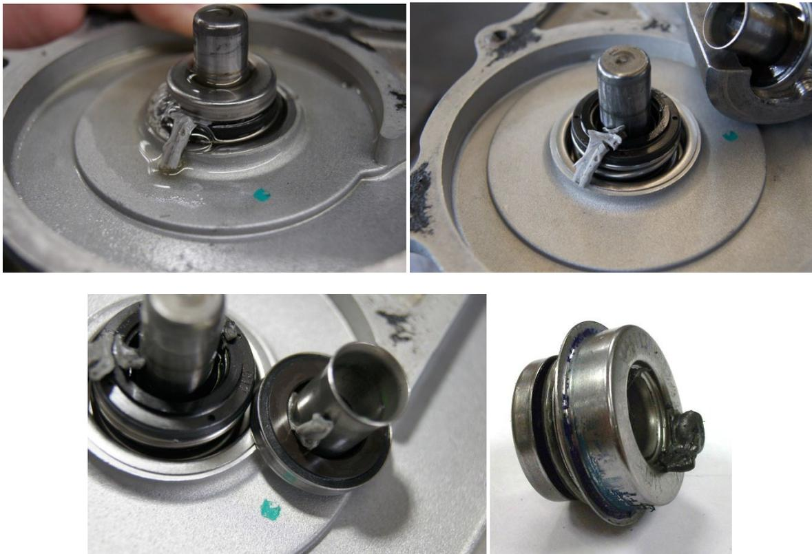
5) Exemplos de contaminação: formação de película de vedação causada pelo uso excessivo de selantes.
