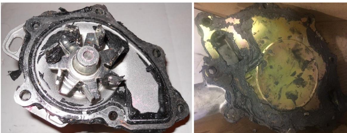
2) Ambas as bombas d'água foram fornecidas com uma junta tipo borracha/o-Ring. Estes tipos de juntas não requerem o uso de quaisquer selantes.
