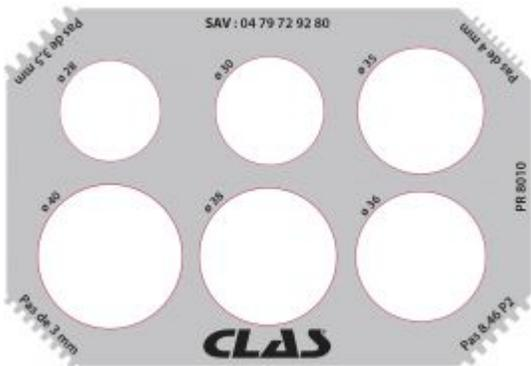
**Libellé article** PLAQUE DE CONTROLE DIAMETRE ET FILETAGE POUR ARBRE
