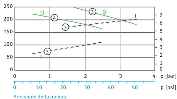
■  $\dot{Q}$  [l/h] Portata in volume ■ I [A] Intensità di corrente con la tensione nominale
