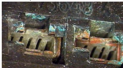
Acoplamento com umidade e sinais de corrosão
