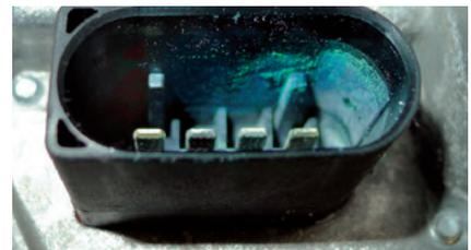
Conector com sinais de corrosão
