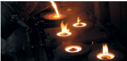
Fundición de piezas brutas de segmentos de pistones (en coquillas)
