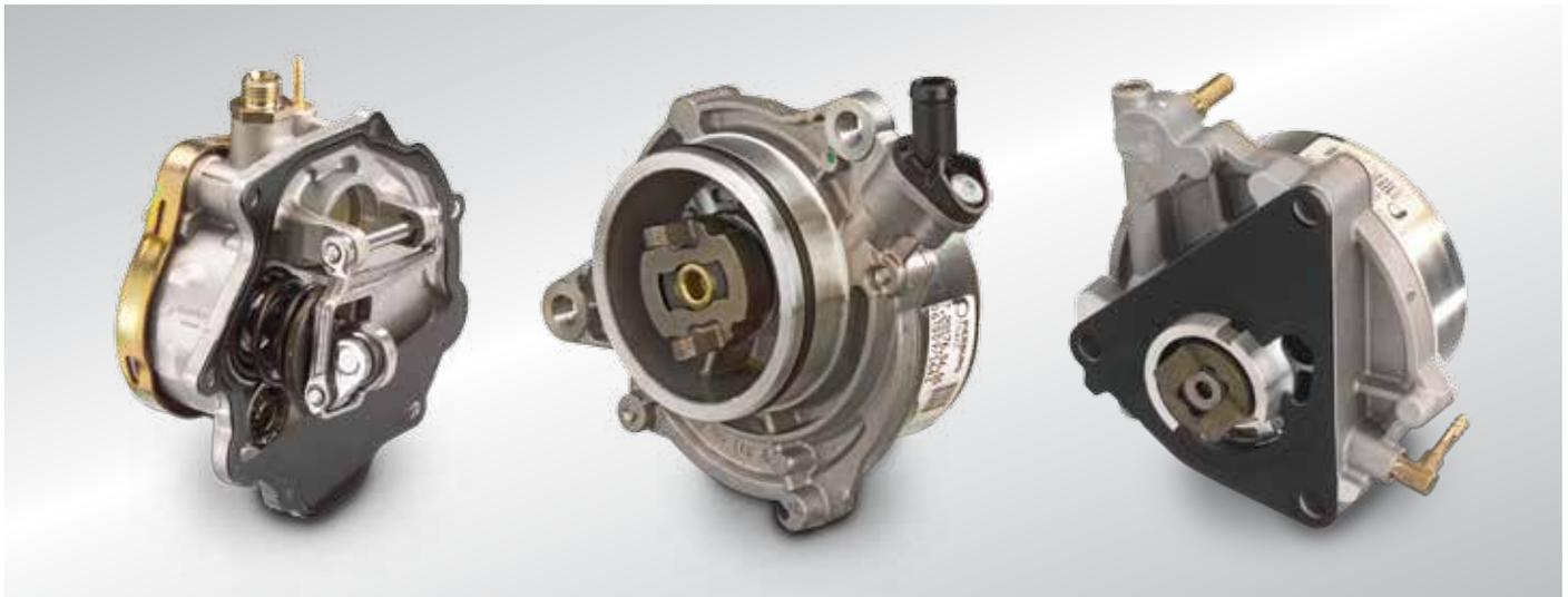
Las bombas de vacío se emplean en vehículos en los que no se puede crear la depresión necesaria en el tubo de aspiración. La depresión se usa como energía servo para los dispositivos neumáticos. De este modo se pueden aplicar grandes fuerzas de ajuste en reducidos espacios de montaje. Como por ejemplo los motores de inyección directa, los motores turbo y los motores
