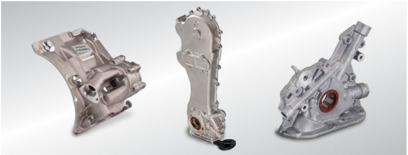
Las bombas de aceite aspiran el aceite del cárter de aceite y lo bombean a los puntos de lubricación del motor a través del filtro de aceite y del enfriador de aceite. El accionamiento de una bomba de aceite puede efectuarse por dentado exterior, dentado interior para el accionamiento directo del cigüeñal o por tomas de fuerza.
