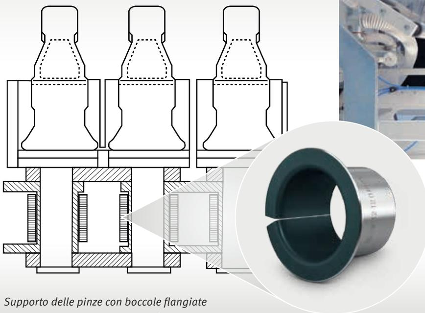
Supporto delle pinze con boccole flangiate a strisciamento KS PERMAGLIDE® P10
