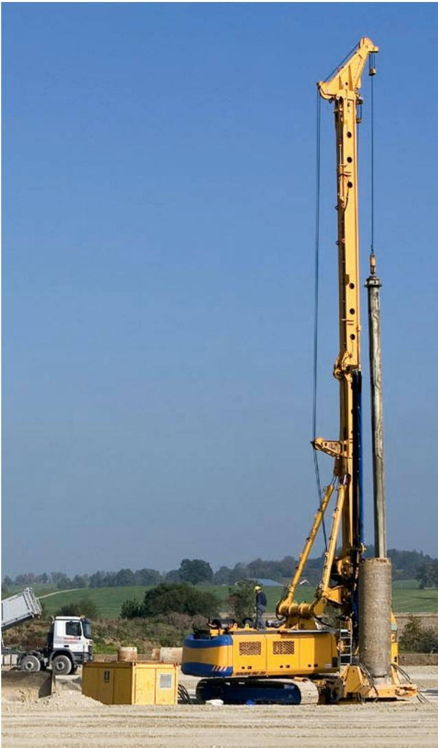
Machine de battage et de forage
