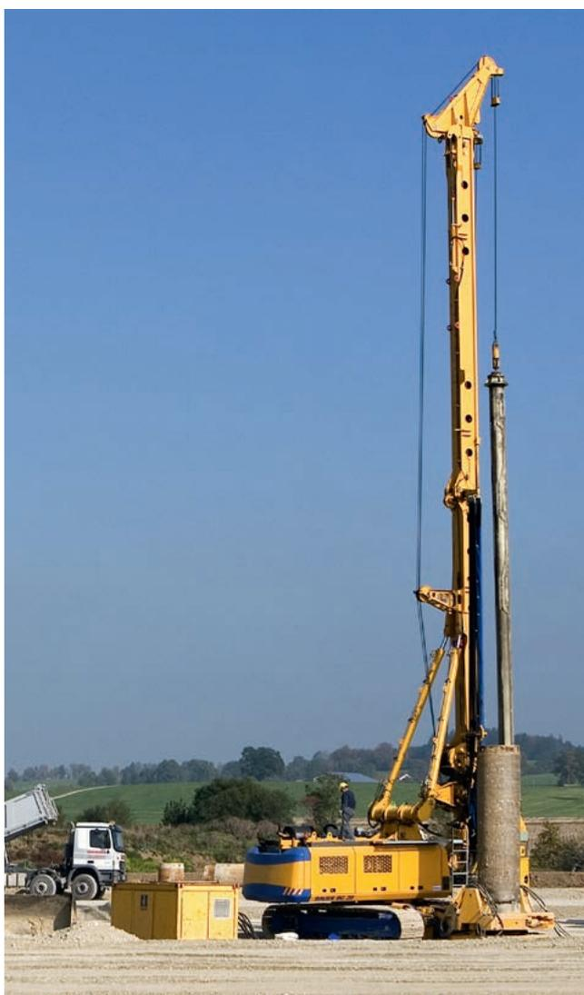
Machine de battage et de forage
