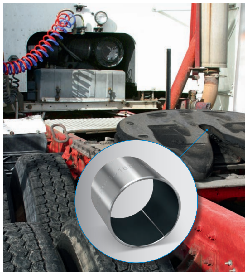
Supporto della ralla con boccole a strisciamento Permaglide® P180
