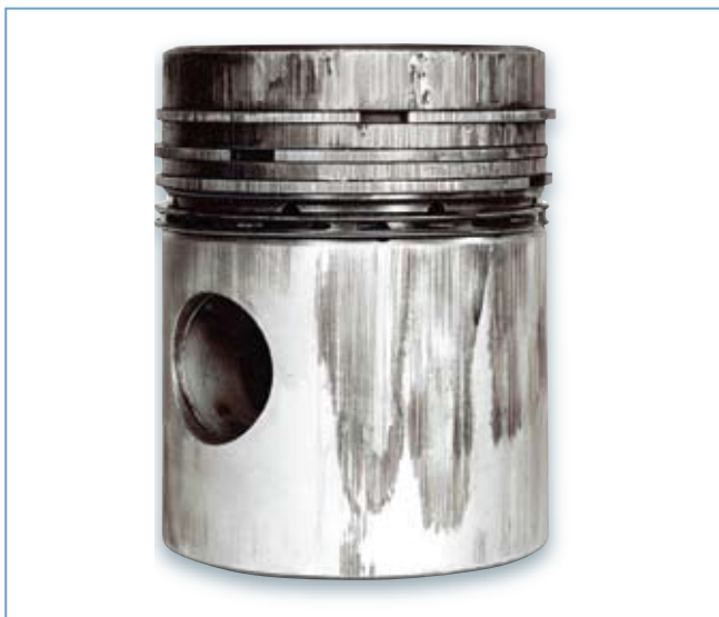
Abb. 1 Überhitzungsfresser mit Schwerpunkt am Kolbenkopf
