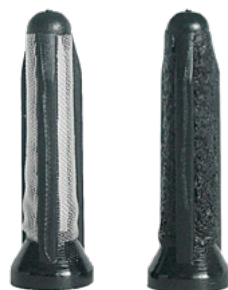
Az E1F előszűrője: balra új, jobbra eldugult állapotban
