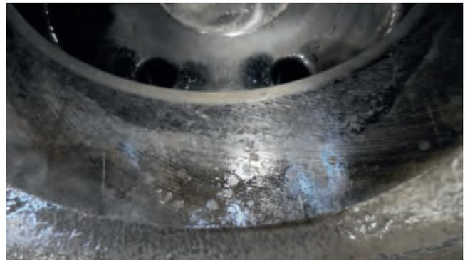
Oberflächenschäden durch Mikroreibung an einem Getriebe
