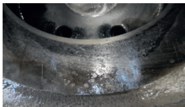
Daños superficiales debido a microfricción en un engranaje
