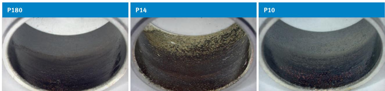
Desgaste de la capa de deslizamiento en cojinetes de fricción de P180, P14 y P10 tras el ensayo de rotación en marcha en seco con carga en los bordes
