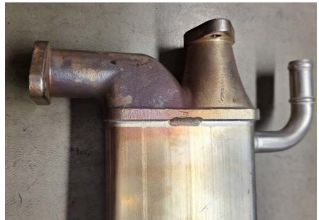
Formation de bulles et de fissures (gauche) et décolorations importantes (droite) – dommages typiques en cas de surcharge thermique
