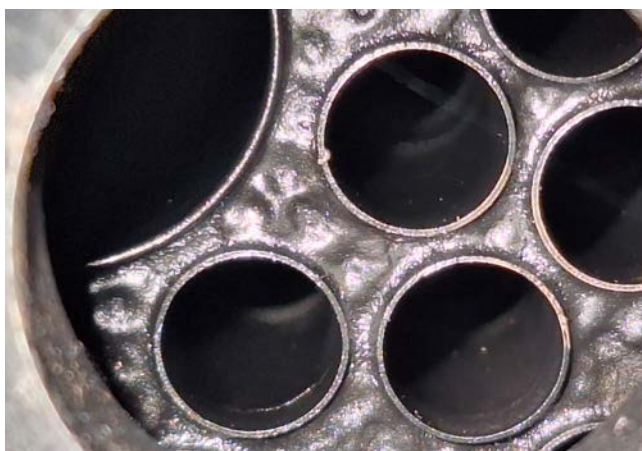
Formazione di bolle e crepe (a sinistra) e decolorazioni evidenti (a destra) – tipologie di danni tipici in caso di sovraccarico termico
