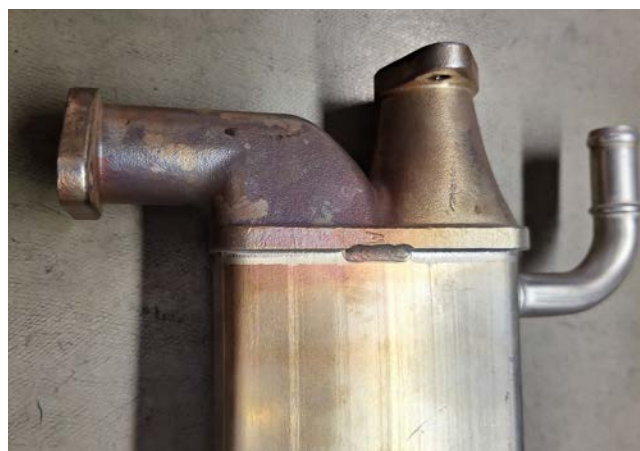
Formazione di bolle e crepe (a sinistra) e decolorazioni evidenti (a destra) – tipologie di danni tipici in caso di sovraccarico termico
