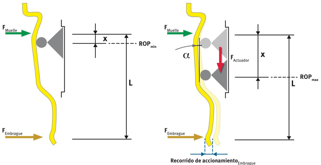
La fuerza pretensora del muelle de presión [ $F_{\text{Muelle}}$ ] en el muelle de retorno y el ratio de presión de palanca [ $x/(L - x)$ ] resultante de la posición [ $x$ ] de la corredera determinan la fuerza de accionamiento del embrague [ $F_{\text{Embrague}}$ ].
