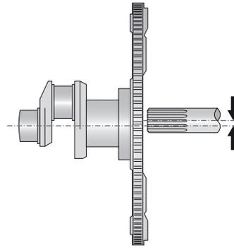
El compensador de desviación se usa aquí para contrarrestar. Utiliza un rodamiento con funcionamiento en seco para proporcionar al embrague doble flexibilidad radial sobre el eje primario de la transmisión. Como tal, los movimientos relativos son dirigidos a través de un disco de fricción duradero y así se evitan las fuerzas radiales de un modo efectivo.
