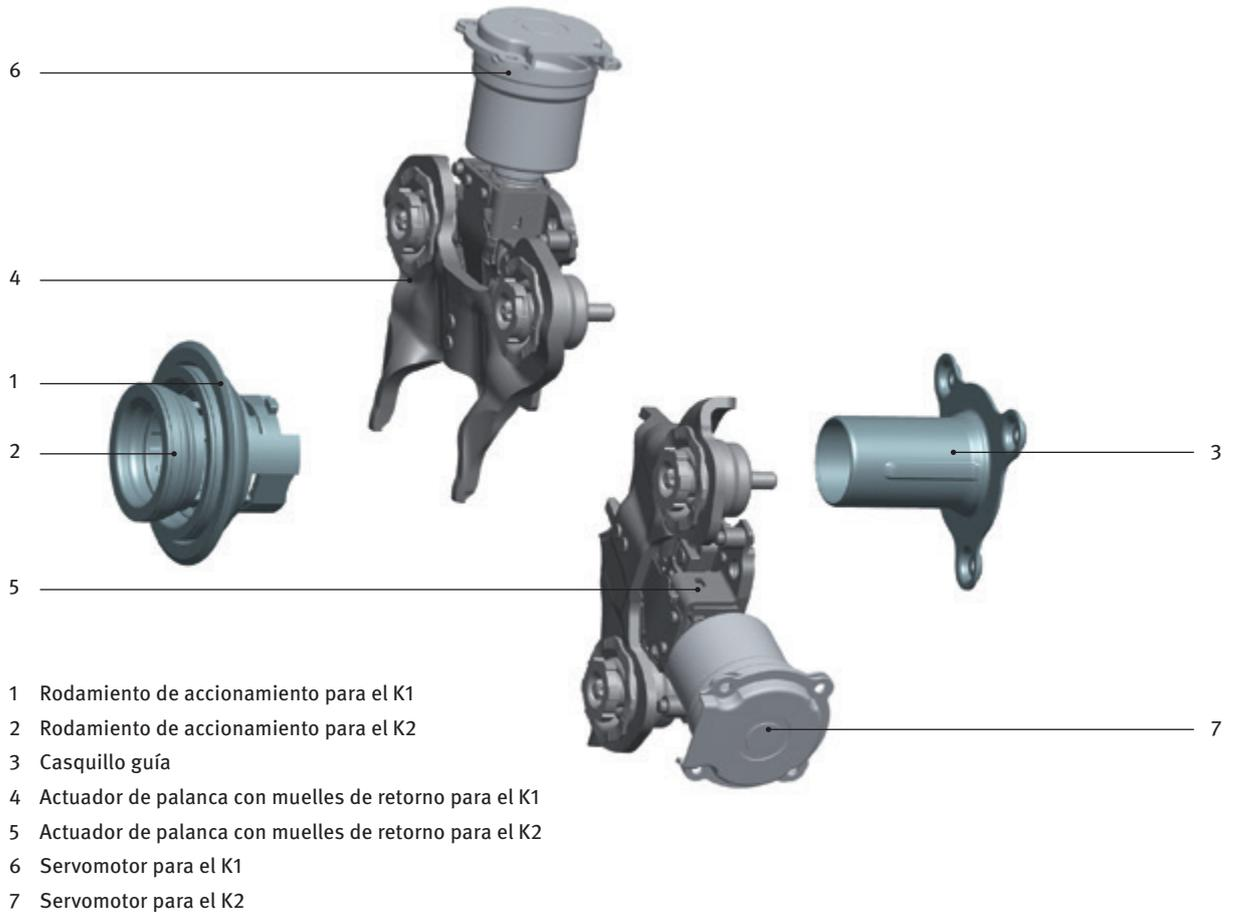
Con las transmisiones manuales anteriores con un único embrague de disco, el embrague está cerrado en reposo. Se abre presionando el pedal del embrague, que desconecta la transmisión de par. Esto se lleva a cabo mediante el «sistema de desembrague».
