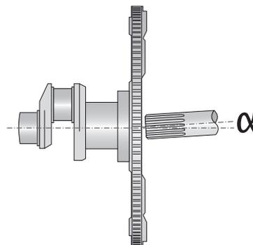
Para compensar la desviación axial y el desplazamiento angular, sin producir desgaste, el embrague doble está montado de forma flexible en el disco de embrague. Como parte de este diseño, los muelles laminados específicamente conformados compensan de manera efectiva la desviación axial y el desplazamiento angular.
