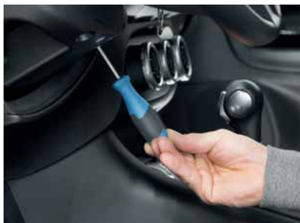
A gyújtáskulcs reteszelése csavarhúzóval oldható
