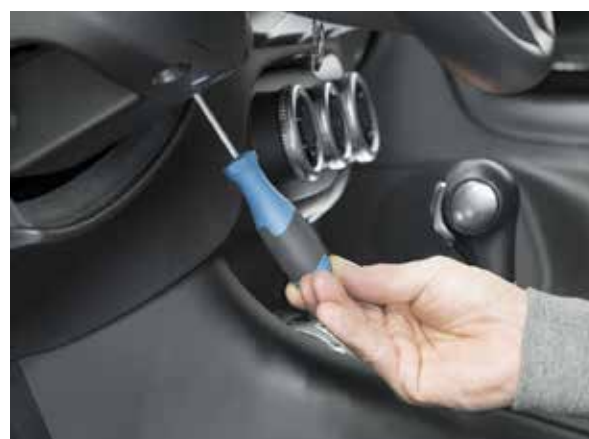
Il dispositivo di bloccaggio della chiave di accensione può essere disabilitato con un cacciavite
