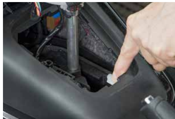
La leva selettoria può essere sbloccata tramite un pulsante
