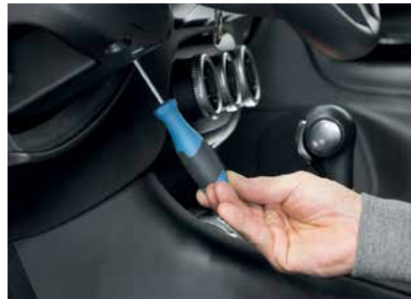
Kontak anahtarını kilitleyen mekanizma ancak bir tornavida yardımıyla devre dışı bırakılabilir.
