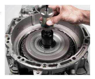
• Sicherungsring an der Getriebeeingangswelle entfernen
