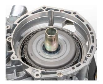
Kupplungsabschlussdeckel waagerecht über die Hülse führen und gleichmäßig von Hand in den Sitz des Getriebes pressen
