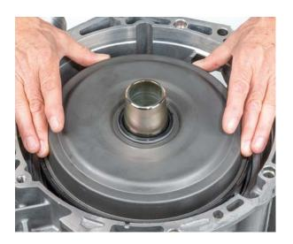
Neuen Sicherungsring des Kupplungsdeckels montieren und vollständig umlaufend in den Sitz des Getriebes hebeln
