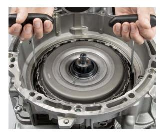
Die Doppelkupplung hat die richtige Einbaulage erreicht, wenn sie beim Einsetzen spürbar den Anschlag im Getriebegehäuse berührt
