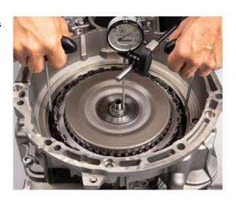
Distanzscheibe bzw. Sicherungsring aus dem Sortiment wählen, dessen Stärke dem errechneten Wert am nächsten kommt. Bei einer Differenz ist immer die nächstgrößere Distanzscheibe bzw. der nächstgrößere Sicherungsring zu verwenden:
