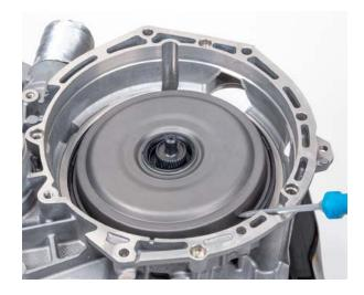
• Sicherungsring der Mitnehmerscheibe mit einem Schlitzschraubendreher heraushebeln
