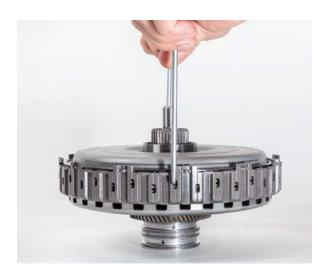
• Lauffläche des Getriebeflansches prüfen. Sie darf keine Einlaufspuren aufweisen
