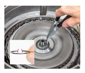
Um die Stärke der Distanzscheibe bzw. des Sicherungsringes zu bestimmen, sind drei (beim DQ 250 Getriebe zwei) Messungen erforderlich
