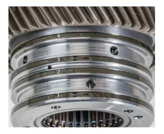
Montagehaken KL-0500-906 wie bei der Demontage in die Bohrungen des Außenlamellenträgers einsetzen
