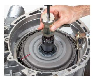
• Sicherungsring der Mitnehmerscheibe im Uhrzeigersinn von der Öffnung beginnend einsetzen
