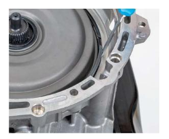
• Kupplungsabschlussdeckel mit einem Schlitzschraubendreher heraushebeln und entfernen
