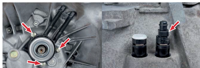
Foto 7: Montaż nowego siłownika
