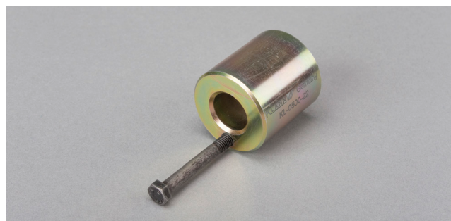
Снимка 3: Центриращата втулка (400 0076 10) трябва да се използва само при двумасови маховици с направляващи щифтове
