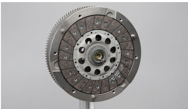
Снимка 5: Фиксирайте фрикционния диск на съединителя
