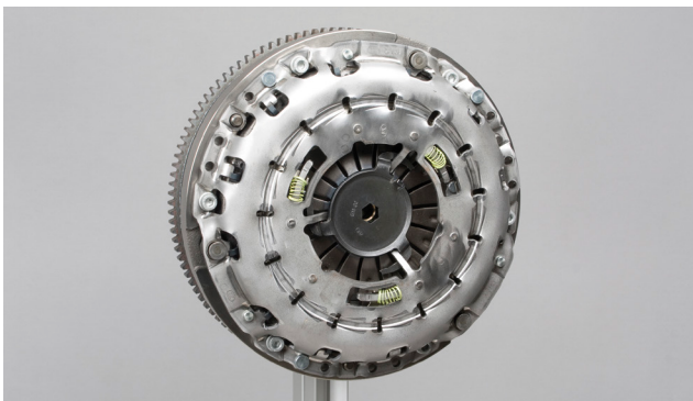
Снимка 7: Сложете притискателния диск на съединителя и затегнете равномерно и последователно болтовете до предписания от производителя на превозното средство въртящ момент на затягане
