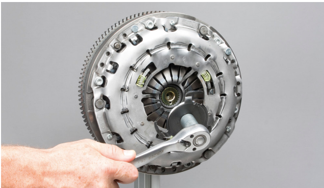
Εικόνα 8: Ξεβιδώστε και αφαιρέστε το στοιχείο ασφάλισης με το κατάλληλο εργαλείο.
