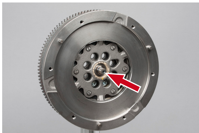
Εικόνα 1: Πείρο-οδηγός στο βολάν διπλής μάζας 415 0377 10
