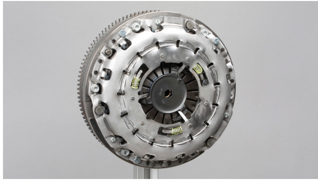
Εικόνα 7: Τοποθετήστε την πλάκα πίεσης και σφίξτε τις βίδες με την προκαθορισμένη από τον κατασκευαστή του οχήματος ροπή σύσφιξης.
