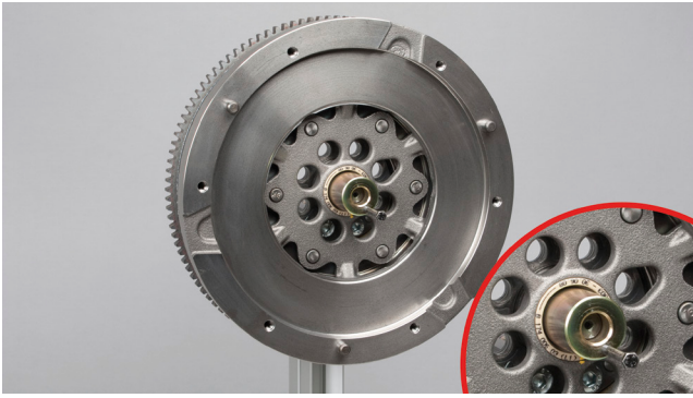
Εικόνα 4: Τοποθετήστε το σωληνωτό πείρο κεντραρίσματος πριν την τοποθέτηση του συμπλέκτη (προσοχή στην τοποθετημένη βίδα)
