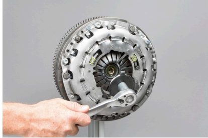
איור 8: שחרר את מתאם הנעילה באמצעות כלי ייעודי מתאים והסר אותו ממקומו. מתאם נעילה זה אינו נדרש יותר.
