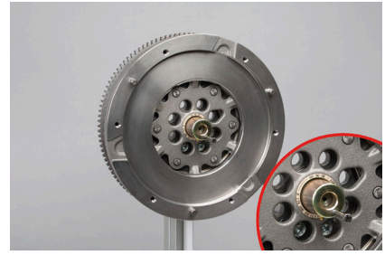
איור 4: שים לב! התקן את שרוול המרכז בטרם תרכיב את המצמד (אנא היזהר מהבורג אשר מותקן עליו).
