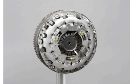
איור 7: התקן את פלטת הלחץ של המצמד ובצע הידוק ברגים בצורה שווה ומסודרת באמצעות מומנט ההידוק אשר מוזכר בנוהל העבודה של יצרן הרכב עליו אתה עובד.
