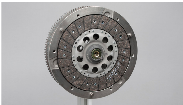
5. ábra: Helyezze fel a tengelykapcsoló-tárcsát
