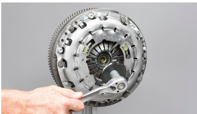
8. ábra: Egy alkalmas szerszámmal csavarja ki a reteszelőidomot és távolítsa el. Arra már nem lesz szükség
