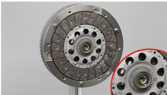
6. ábra: Távolítsa el a csavart a központosító hüvelyből
