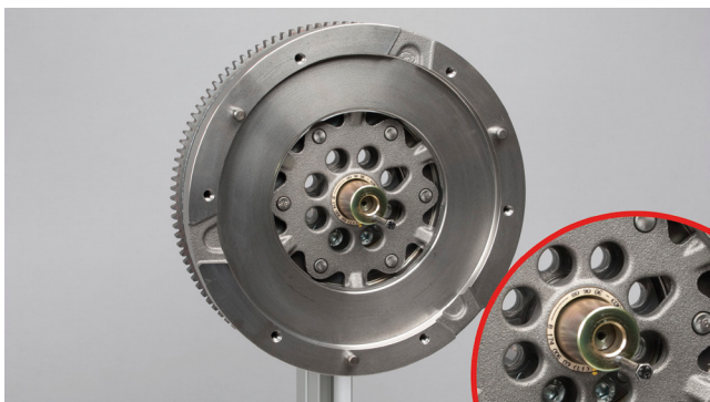
4. ábra: A központosító hüvelyt a tengelykapcsoló szerelése előtt helyezze fel (ügyeljen a ráhelyezett csavarra)
