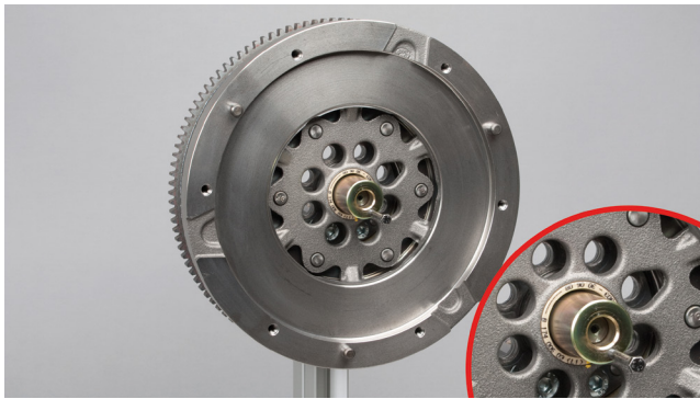
Figur 4: Monter sentreringsmuffen før montering av clutchen (se opp for den monterte skruen).
