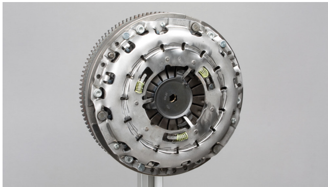
Figur 7: Fest clutchens trykkplate og stram til skruene jevnt og sekvensielt ved å bruke dreiemomentet som er opplyst av kjøretøyprodusenten.
