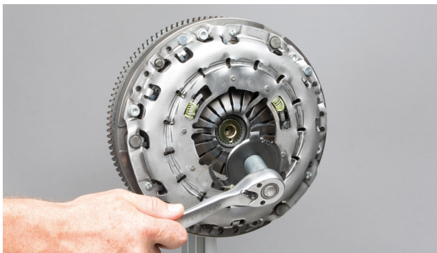
Figur 8: Skruen løst låseelement med egnet verktøy og fjern det. Dette er ikke lenger nødvendig.
