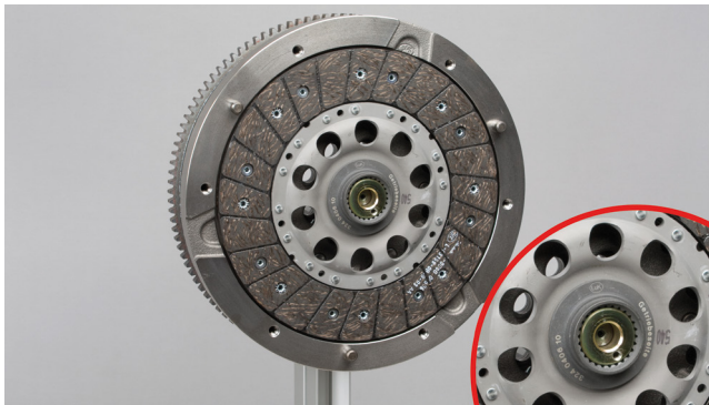
Figur 6: Fjern skruen fra sentreringsmuffen.
