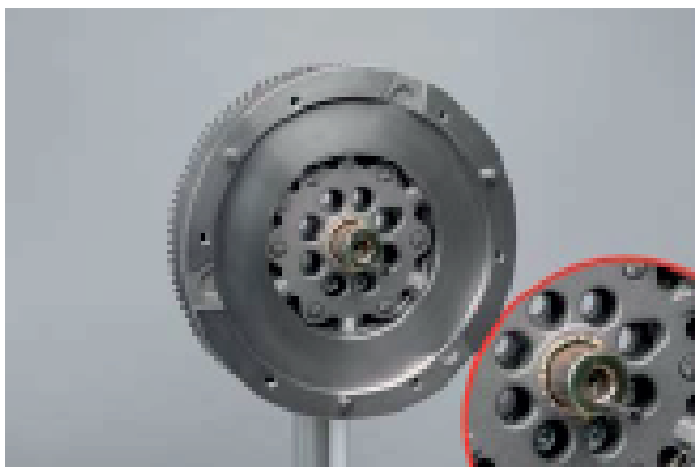
Foto 5: Zamontować tuleję centrującą przed zamontowaniem sprzęgła (uwaga na zamontowaną śrubę)
