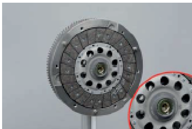
Foto 6: Wykręcić śrubę z tulei centrującej.
