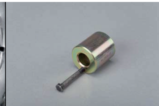
Foto 3: Tuleja centrująca (400 0076 10) musi być używana jedynie w przypadku dwumasowych kół zamachowych z kołkami centrującymi.
