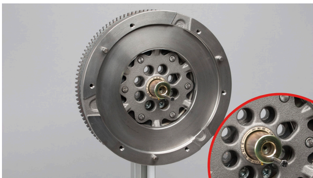
Рисунок 4: Установите центрирующую втулку перед установкой сцепления (обратите внимание на установочный винт)
