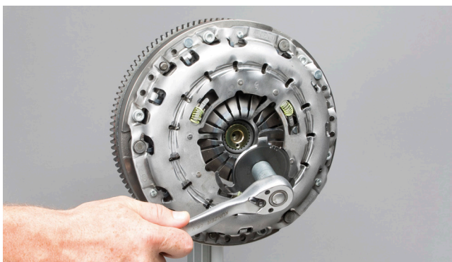
Рисунок 8: Снимите фиксатор специальным инструментом. Он больше не потребуется
