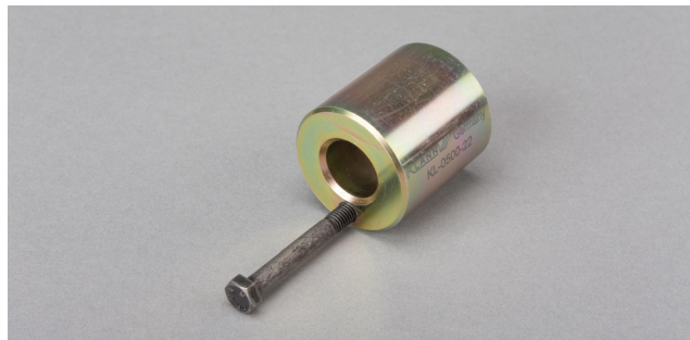
Bild 3: Centreringsbussning (400 0076 10) används vid dubbelmassesvänghjul med styrtapp
