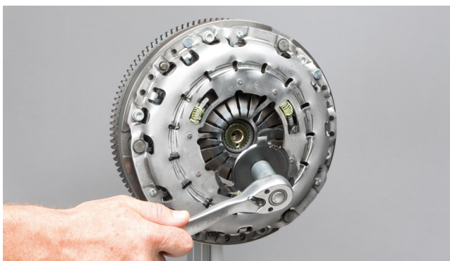
Bild 8: Vrid och ta bort blockeringsverktöget med lämpligt verktyg. Detta kommer inte att behövas mer
