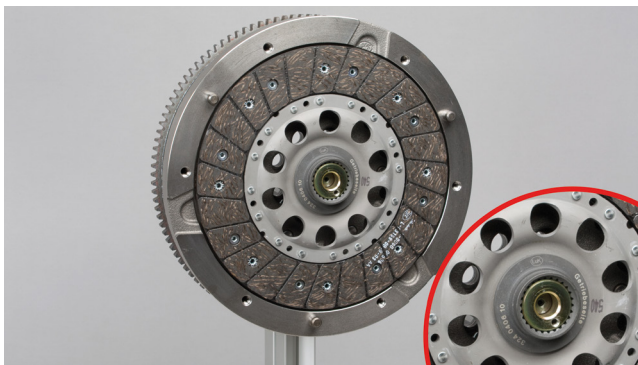
Bild 6: Skruva loss skruven från centreringsbussningen
