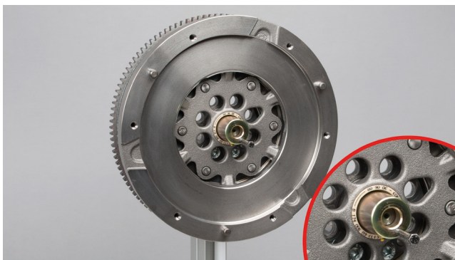
Bild 4: Sätt på centreringsbussningen före montering av kopplingen (glöm inte att sätta dit utdragsskruv)
