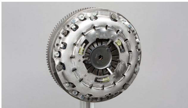
Bild 7: Sätt på kopplingens tryckplatta och dra åt skruvarna med det av fordonstillverkaren rekommenderade åtdragsmomentet
