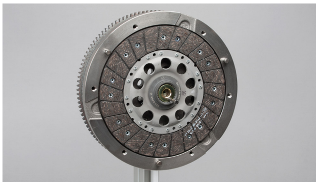
Bild 5: Sätt på kopplingslamellen
