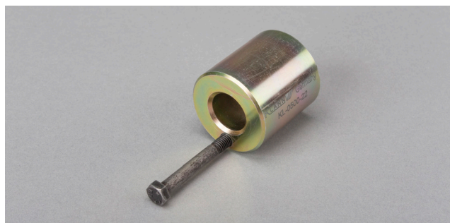
Зображення 3: Центрувальну втулку (400 0076 10) слід використовувати для двомасового маховика з направляючим стрижнем
