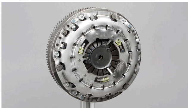
Зображення 7: Встановіть натискний диск зчеплення і рівномірно закрутіть гвинти з визначеним автовиробником моментом затягування
