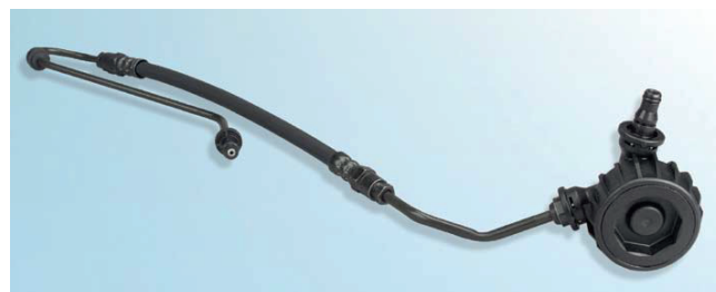
Foto 1: Przewód hydrauliczny z regulatorem częstotliwości (element antywibracyjny)
