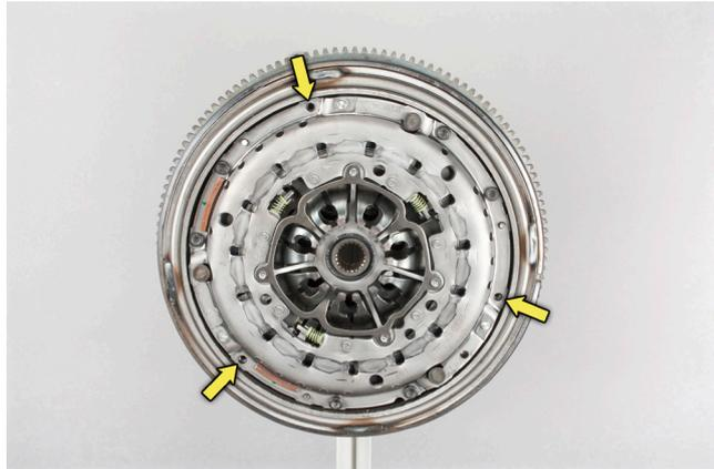
Рисунок 9: В оставшиеся отверстия закрутите винты нажимного диска и затяните усилием в  $10,5 \pm 1$  Нм.
