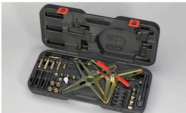
Рисунок 2: Специнструмент SAC 400 0237 10
