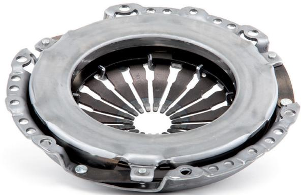
Bild 1: Druckplatte des LuK RepSet® 620 3268 00
