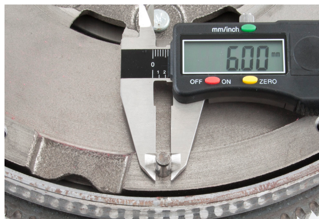
Зображення 1: Вимірювання діаметра центрального штифта
