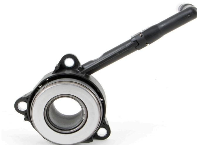
Prilikom odzračivanja hidrauličkog potisnog ležaja važno je pridržavati se propisanog postupka
