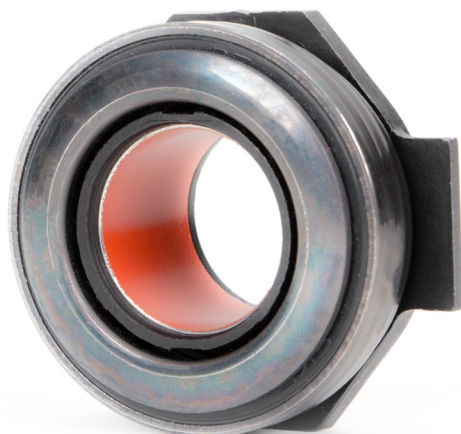
איור 3: מיסב שחרור עם שריוול מוביל המצופה טפלון - אסור לבצע גירוז
