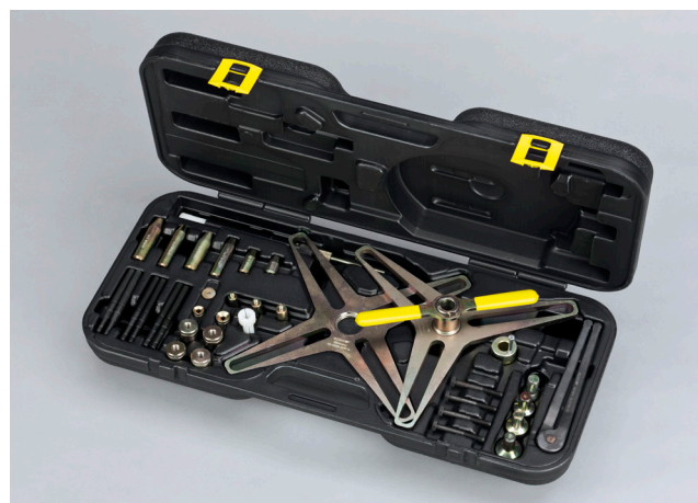
Зображення 1: Спеціальний інструмент 400 0237 10 для монтажу зчеплення
