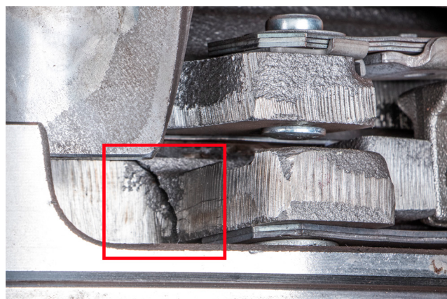
1. ábra: A tangenciális laprugó felfogására szolgáló fül törése
