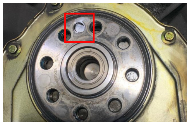
Afbeelding 2: Referentiemarkering op de krukas
