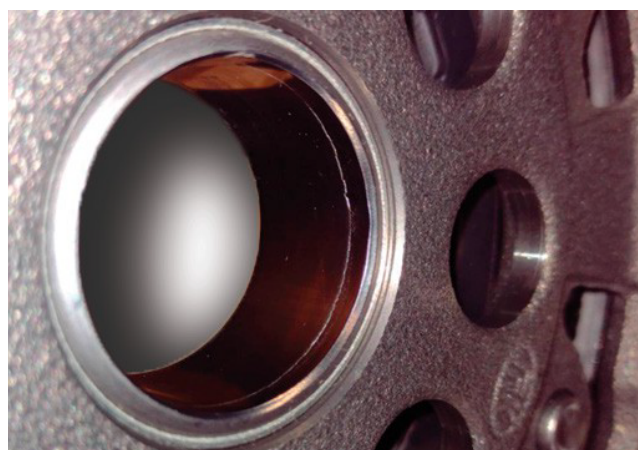
Foto 2: Fałda materiału na flanszy łożyska o niskim profilu
