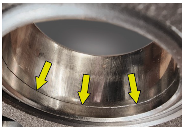
Foto 1: Obwodowe zagięcie materiału na flanszy łożyska DKZ
