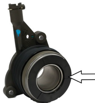
Foto 1: Nowa wersja CSC 510 0235 10/11/12 z plastikowym pierścieniem oporowym
