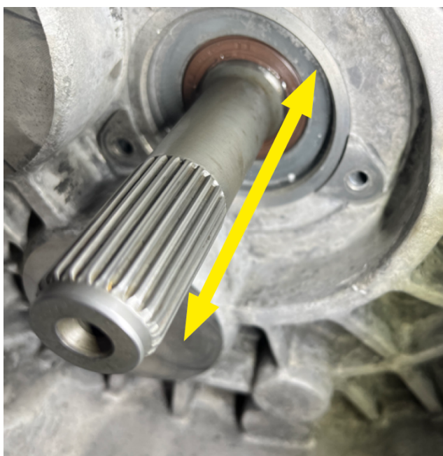
Foto 2: Luz osiowy wału wejściowego skrzyni biegów
