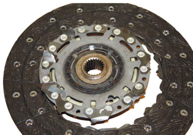
Immagine 2: Mozzo del disco della frizione rotto
