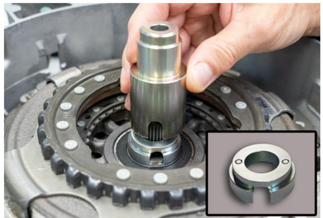
Figura 1: Boccola in combinazione con l'adattatore KL-0500-6031 Z LUK
