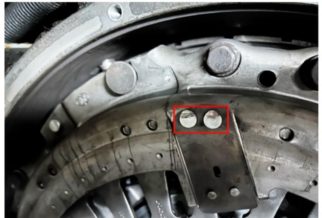
Figura 1: Usura dei rivetti dovuta a una forcella di disinnesto non corretta
