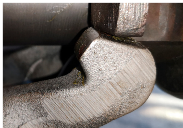
Imagen 1: Horquilla de desembrague con perfil de leva plano
